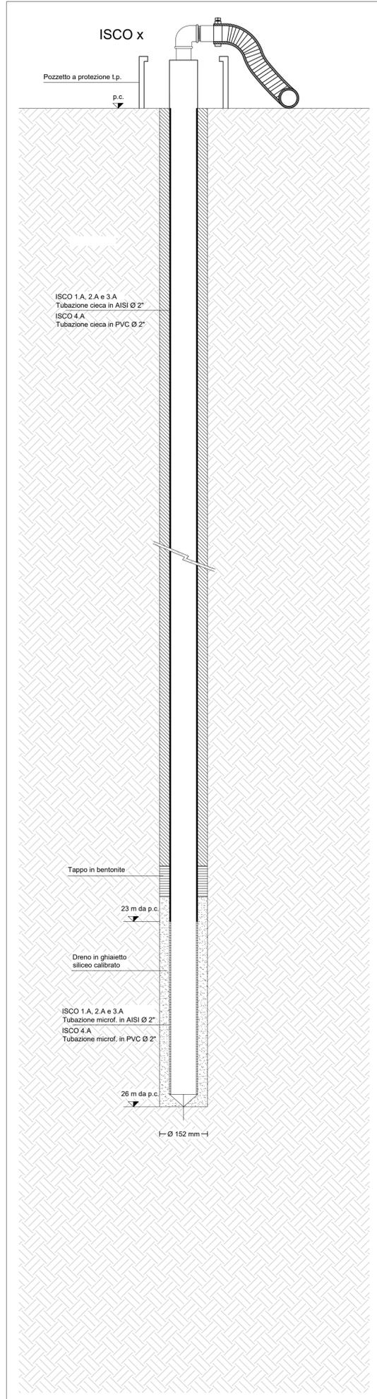
Tipologico piezometri di controllo (non in scala)
