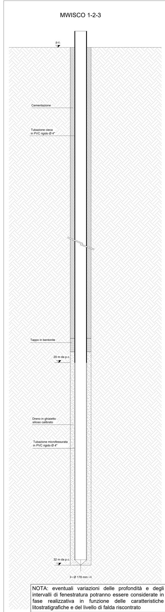
NOTA: eventuali variazioni delle profondità e degli intervalli di fenestrazione potranno essere considerate in fase realizzativa in funzione delle caratteristiche litostratigrafiche e del livello di falda riscontrato
